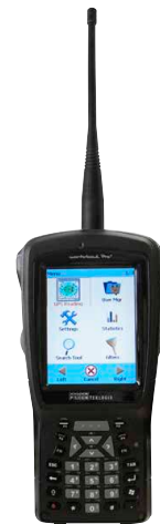
Hệ thống đọc bằng sóng khi đi qua đồng hồ
